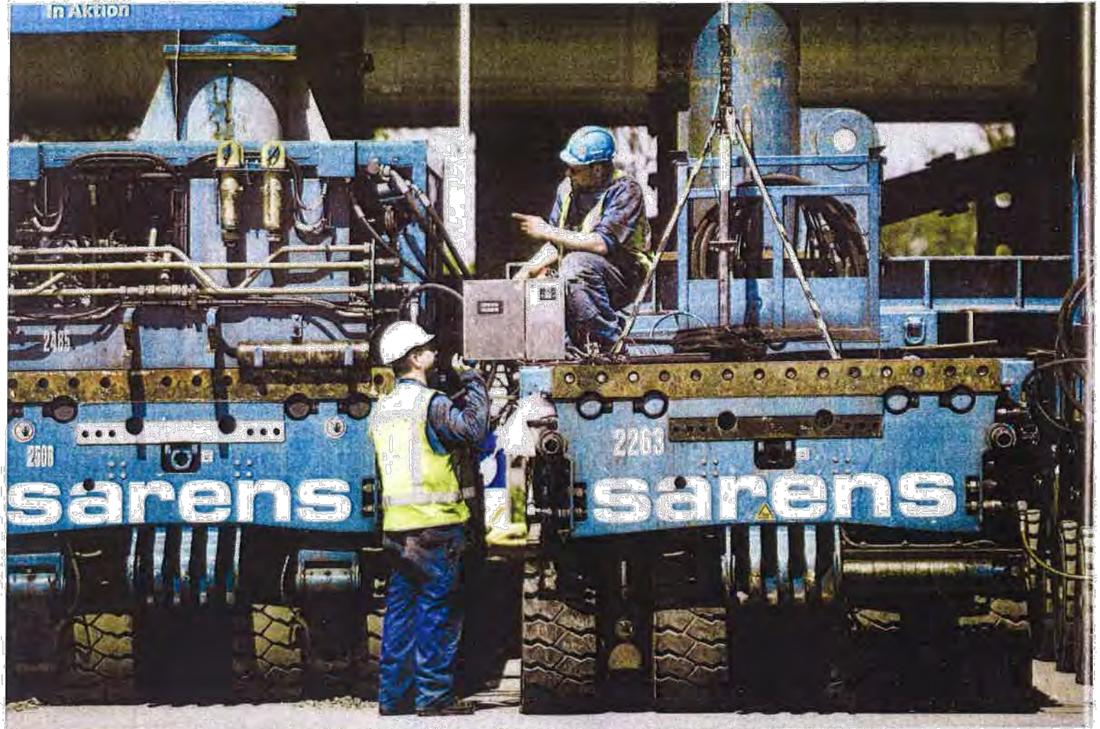
Über ein kabelloses Datensystem wurden die beiden SPMT-Gruppen verbunden.
