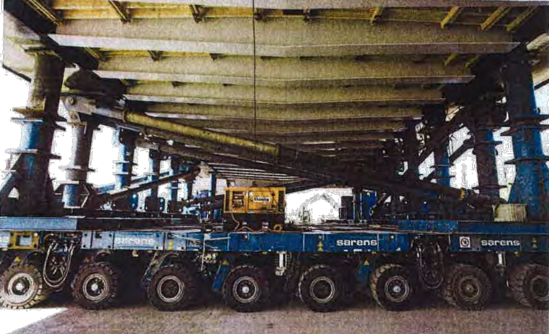
Insgesamt 244 Komag-Achslinien setzte Sarens für den Transport der Brücke ein. Bild: Hermann Schulte
