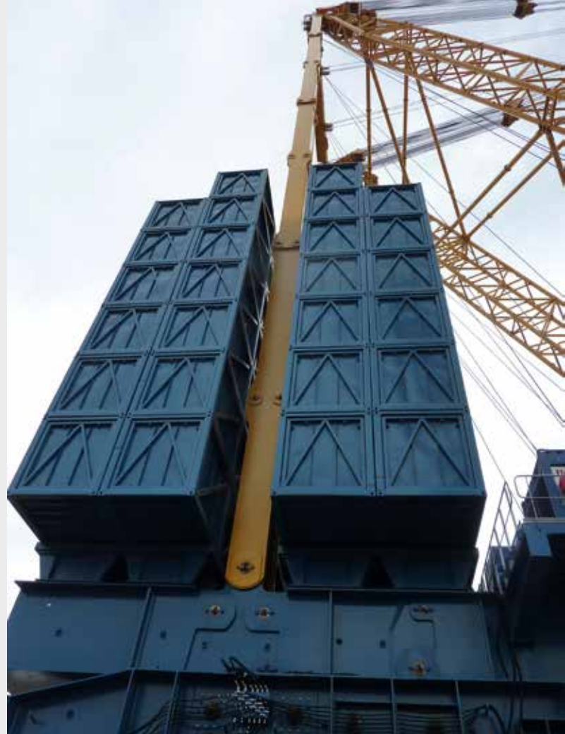
65 m lange Streben sorgen für Verbindung am Gegenausleger.
