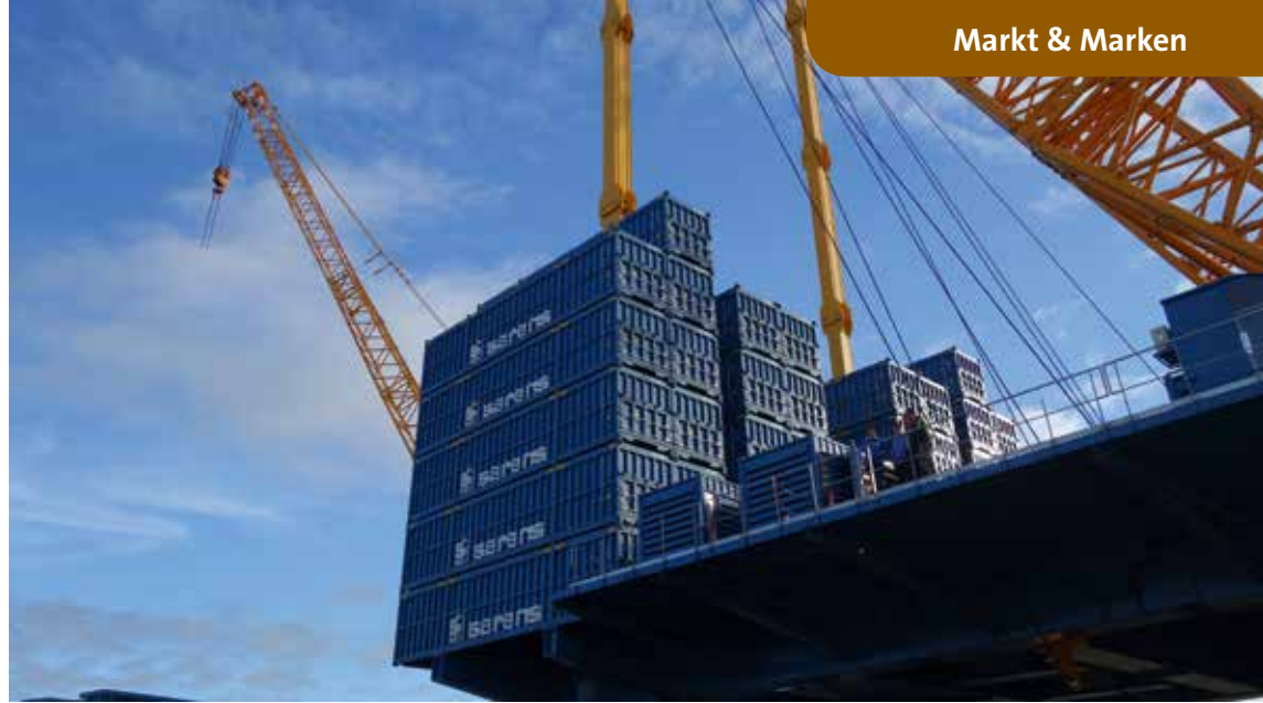
Mehr Ballast: der SGC-140 wird mit 40 Gegengewichtscontainern á 100 t fit für den Einsatz gemacht.
