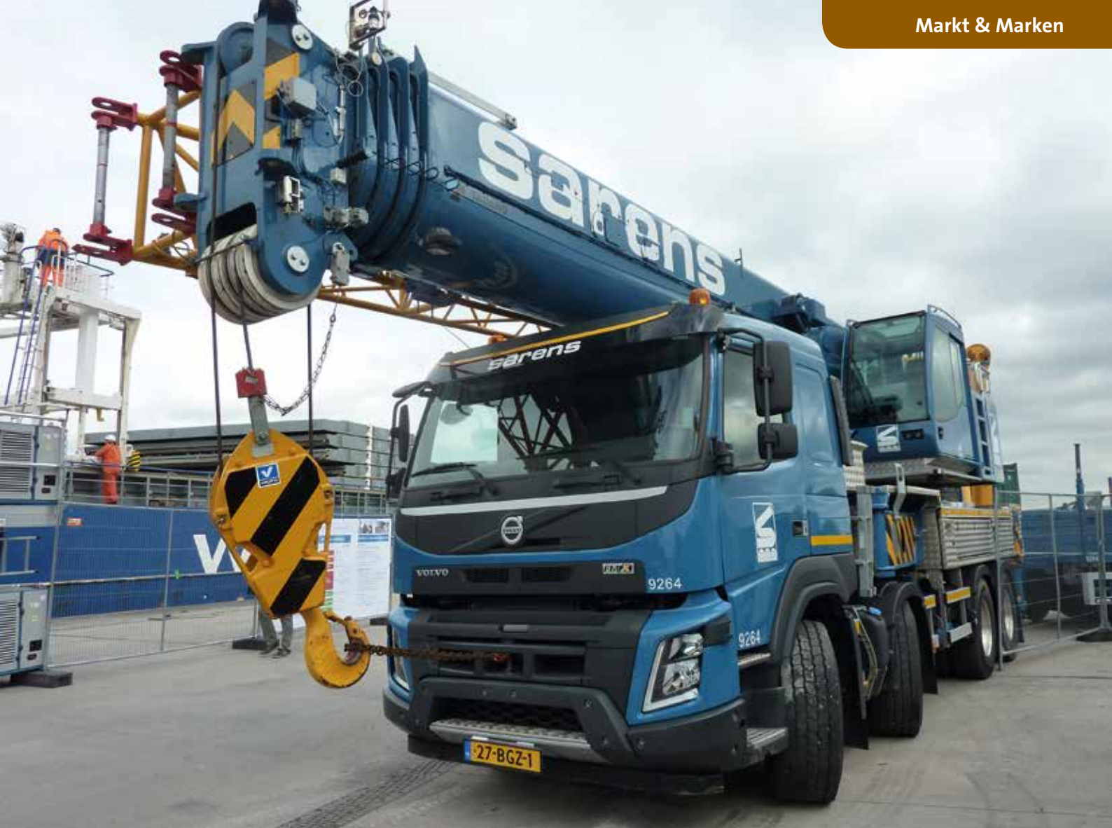
Neben dem neuen SGC-140 gab es noch weiteres Sarens-Equipment zu sehen, darunter auch den auf einem 4-achsigen Volvo-Fahrgestell aufgebauten HK 60 von Tadano.
