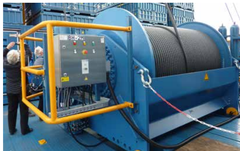
Der SGC-140 ist mit sechs Winden des Typs Zollern ZHP 4.36 ausgestattet. Es besteht aber die Möglichkeit, insgesamt acht Winden unterzubringen.
