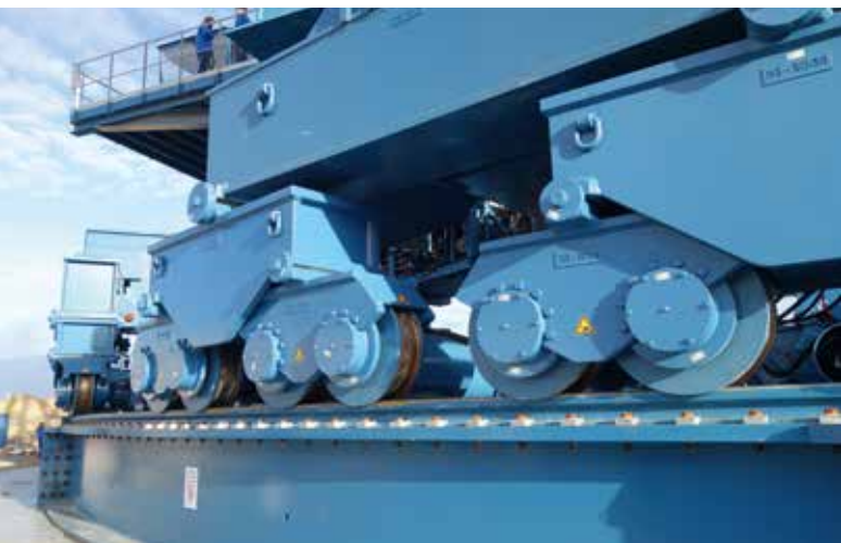
64 Vorder- und 32 Hinterräder sorgen für Beweglichkeit auf dem Ring.
